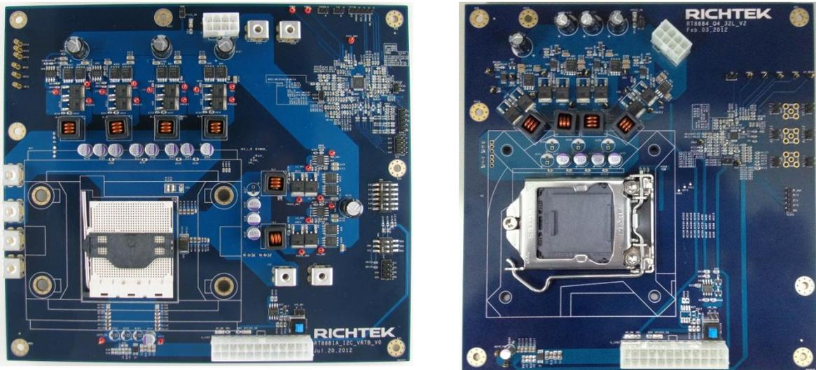
图一、立锜的 CPU 模拟板。(a) AMD SVI2 处理器, (b) 英特尔 VR12.5 处理器。
